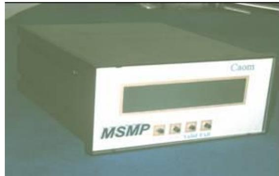
Le système est prévu à commander quatre relais en cas de dépassement d'une des limites d'alarme ou d'avarie. Le dispositif peut être connecté sur un réseau RS485 afin de surveiller sur ordinateur des mesures d'entrée.
